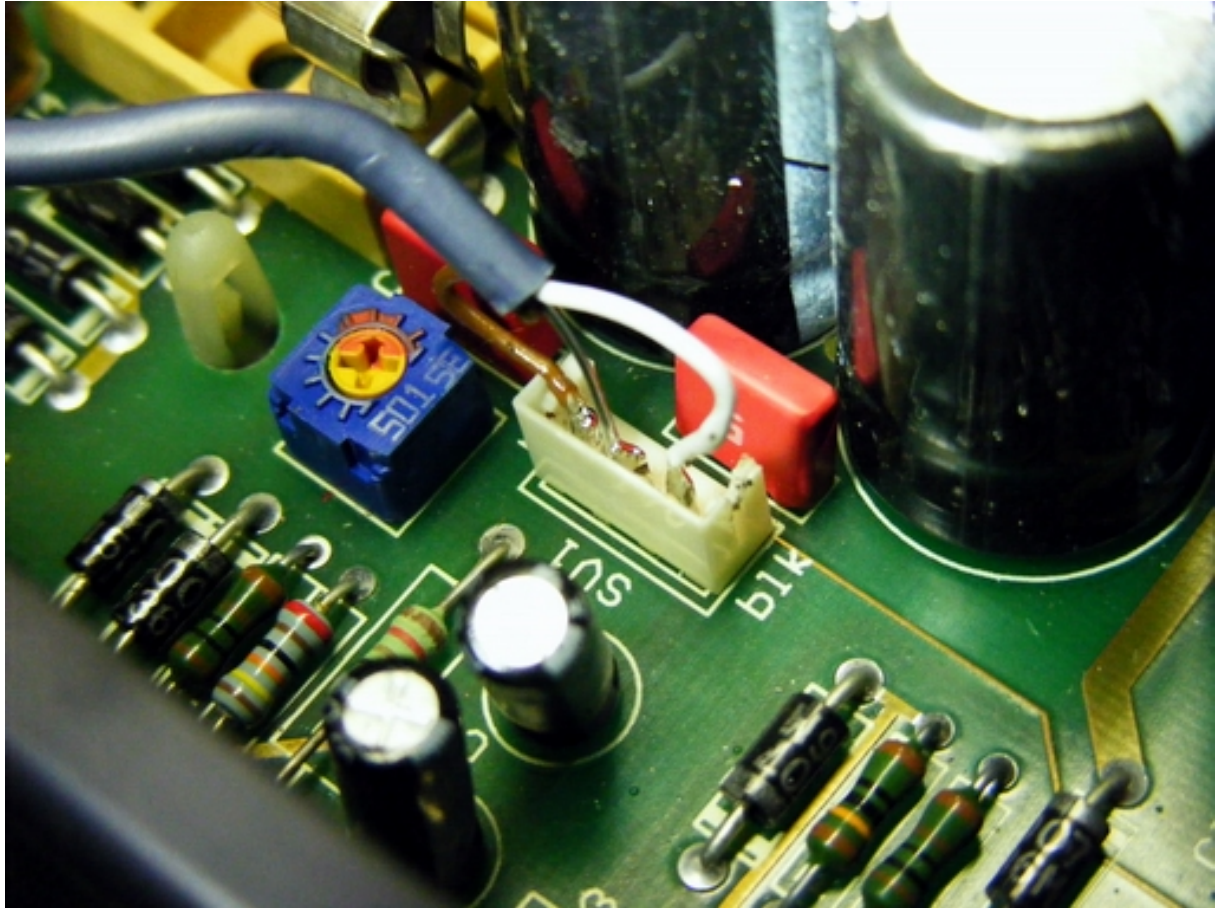
Bild: Phantomspeisung an Klemme SV1.
