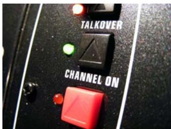
Bild: Der „Channel-On Taster“
