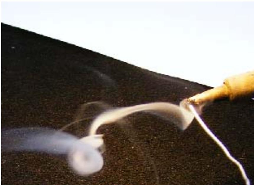
Bild: Lötzinn ist giftig da es Schwermetalle beinhaltet und Flussmitteldämpfe absondert
