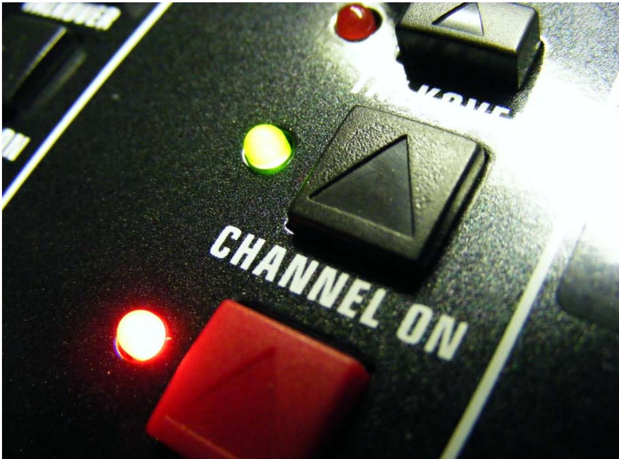
Bild: Die LED am Schalter Channel-On muss ausgewertet werden, damit das Rotlicht NUR bei eingeschalteten Kanal aktiviert wird.
