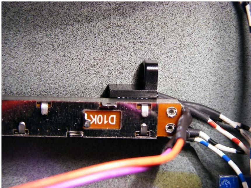
Bild: Eingeklemmte Gabellichtschanke am Fader
