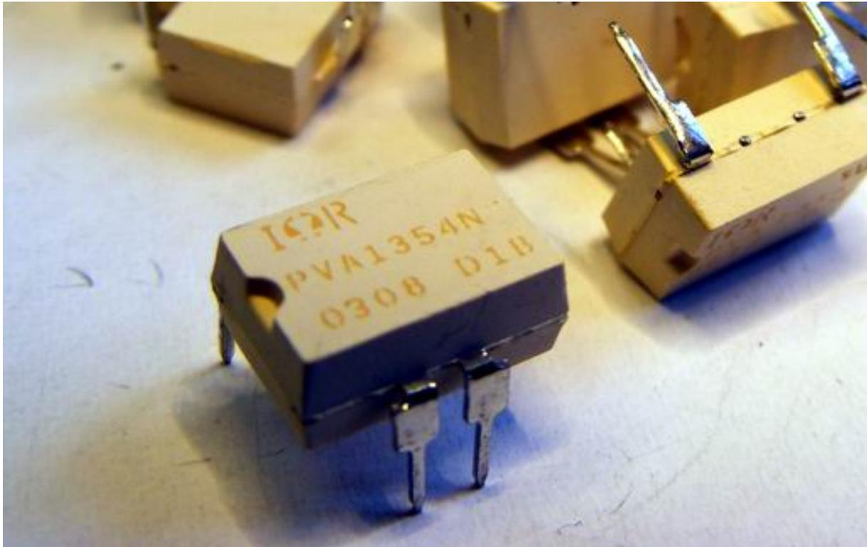
Bild: PVA1354 – der analoge „Alleskönner“ Optokoppler. Oftmals auch als „Solid-State Relay“ bezeichnet, finden diese IC als Relaisersatz Anwendung.
