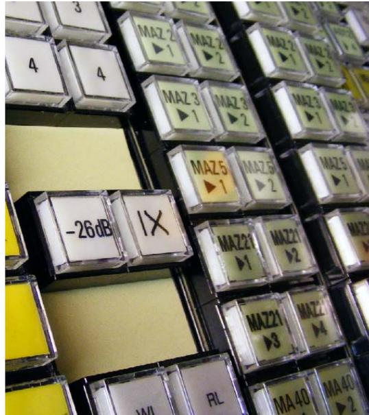
Bild: Leuchtdrucktaster aus „Danner-Kassetten“ vom Hersteller „eao“
