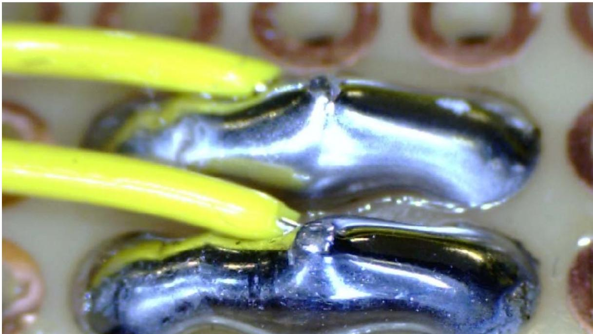
Bild: Lötstelle einer Lochrasterplatte mit Teflon Draht.
