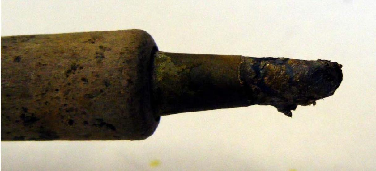
Bild: Absolut unbrauchbare Lötspitze, die KEINE Hitze mehr an Bauteile und Lot überträgt. Sie kocht nur „planlos“ vor sich hin – mehr nicht!
