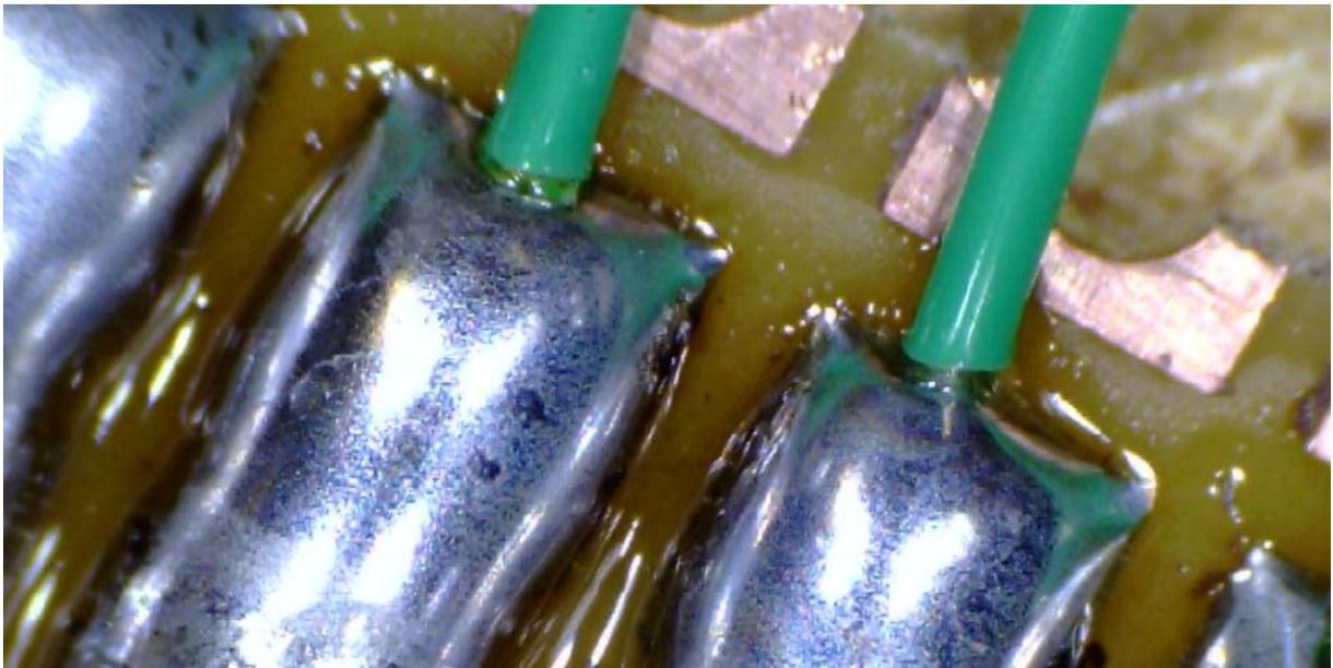
Bild: Bleifreie Lötstelle – ebenfalls mit unzulässigen Flussmittelresten
