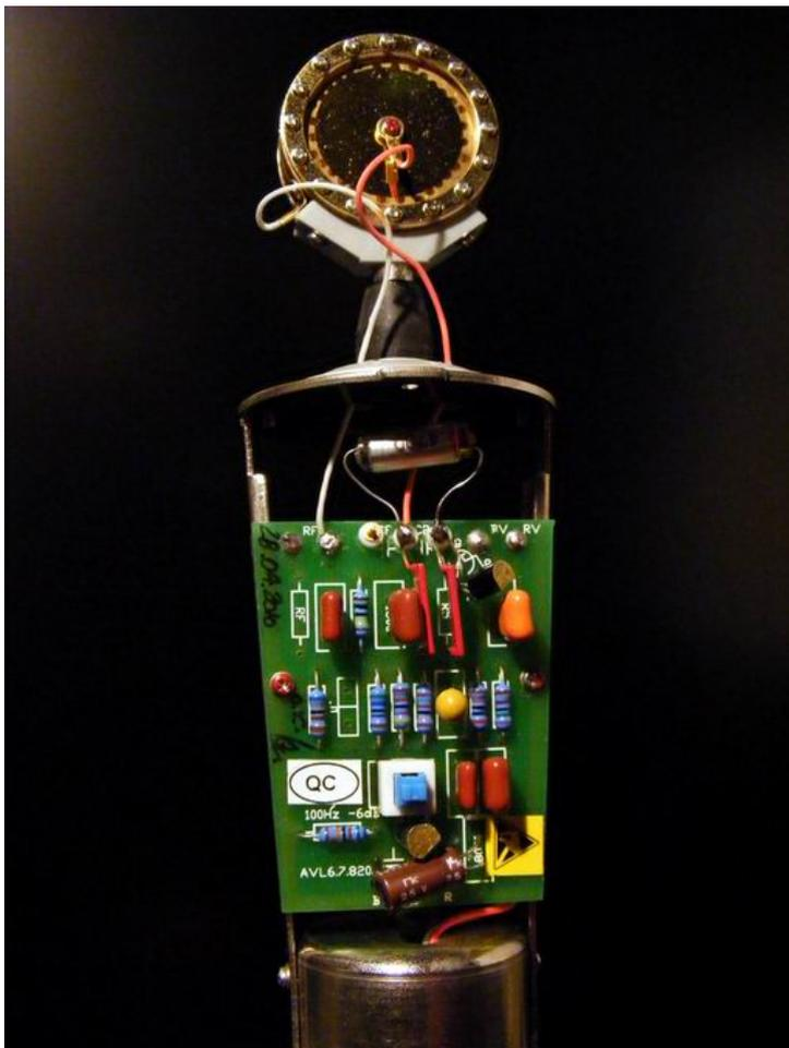
Bild: Gut ersichtlich die beiden Widerstände, die zur Kapsel gehen.
