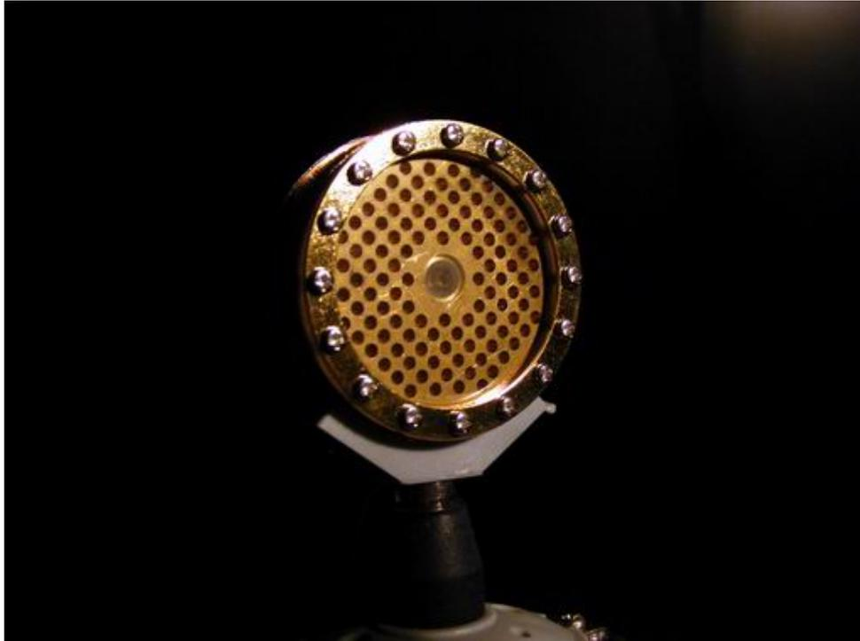
Bild: Kapsel eines Großmembranmikrons (Rückseite)
