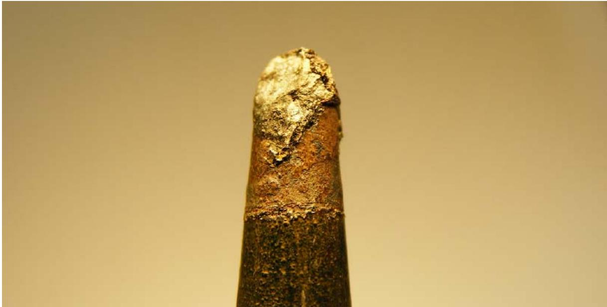
Bild: Kupferfraß einer Lötstelle
