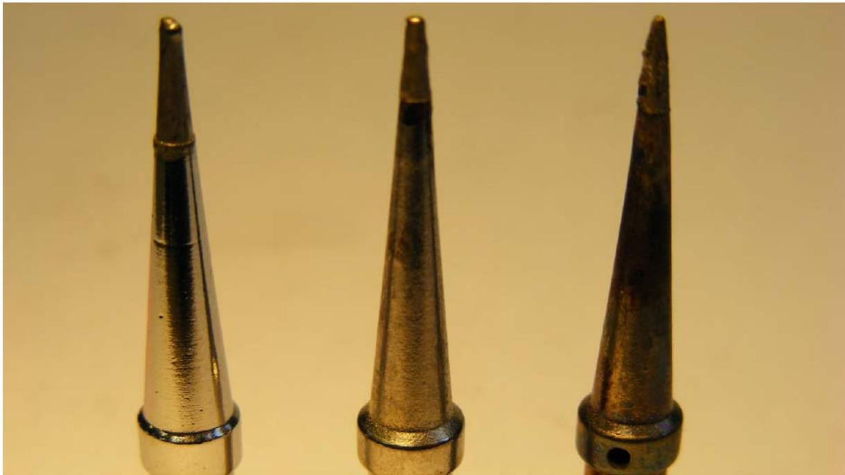
Bild: Drei Lötspitzen. Von Links nach Rechts die Neue, benutzte und vergammelte Lötspitze.
