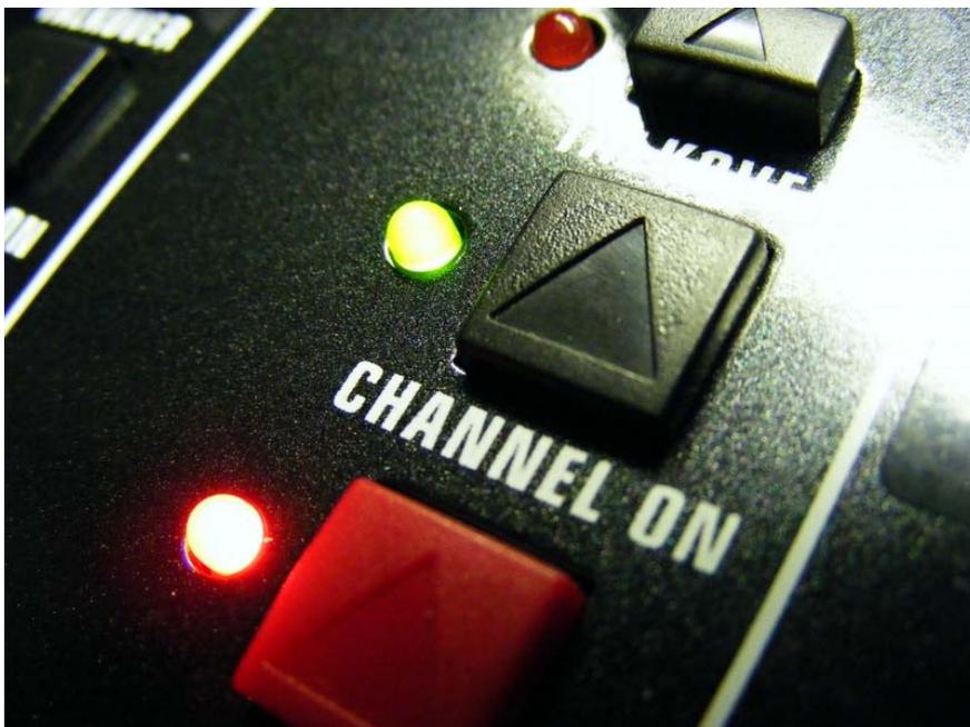
Bild: Die Taste „On“ bewirkt eine Freigabe der Rotlichtfunktion bei geöffnetem Fader.
